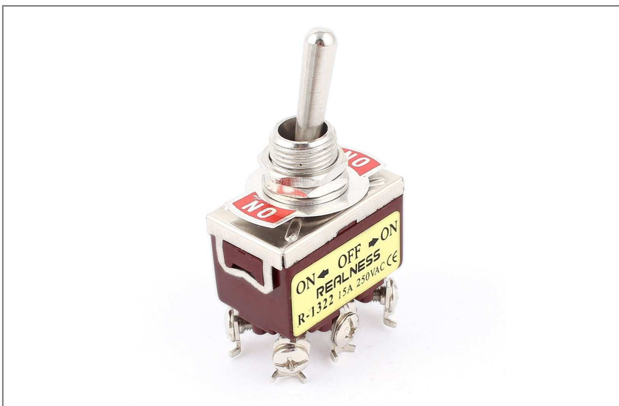
Obr. 2: Trojpolohový dvoupólový přepínač se značením ON-OFF-ON, který je použitelný pro reverzaci malých stejnosměrných elektromotorků
